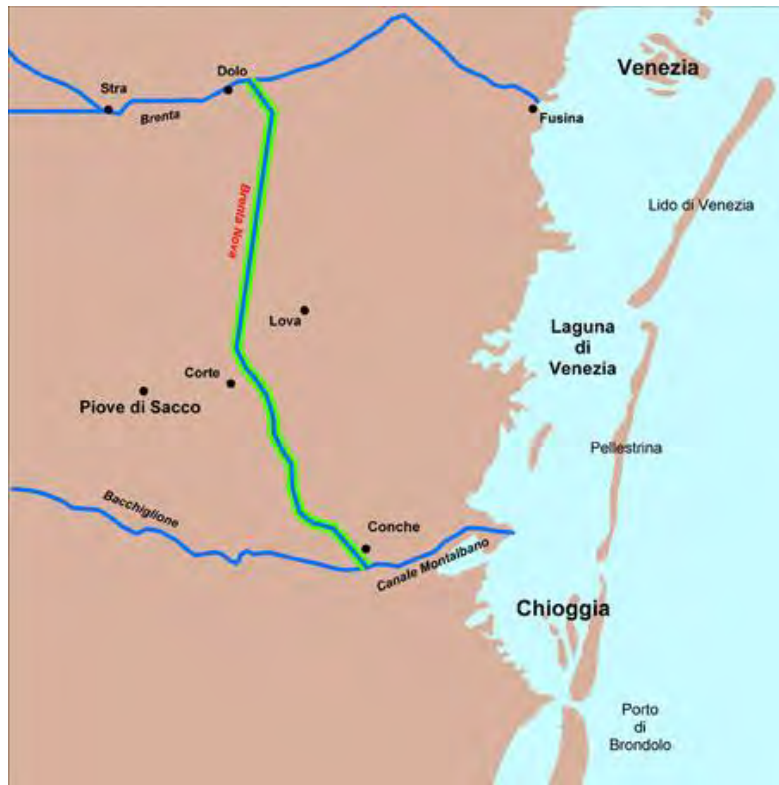
SCHEMA 1. Nel 1507 è ultimato lo scavo della Brenta Nova che da Dolo raggiunge Conche dove è fatta sfociare assieme al Bacchiglione nella Laguna di Venezia tramite il Canale di Montalbano.
